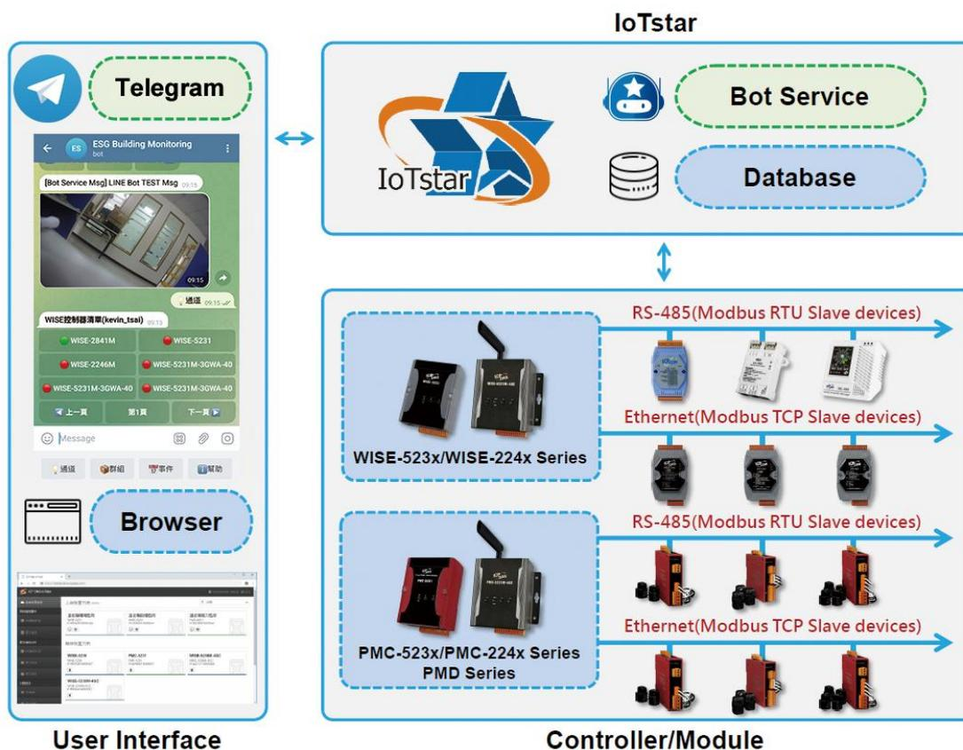
圖 1-2 : IoTstar 2025 「聊天室服務(Telegram)」架構圖
